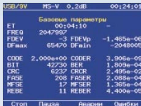
Мониторинг ошибок FAS, AIS и удаленного аварийного сигнала FAS предоставляет возможность секционировать каналы E1 и таким образом локализовать источник ошибок. Например, присутствие удаленного аварийного сигнала FAS указывает на неполадку в приемном оборудовании потока, а наличие AIS – в передающей системе.
