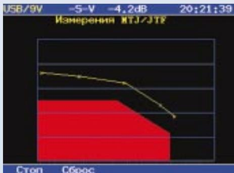
Анализатор BERcut-E1 обеспечивает не только измерение параметров джиттера, но также и функции генератора джиттера. Комбинированное использование генератора и анализатора джиттера позволило реализовать в приборе функции измерения параметров устойчивости устройств к джиттеру (MTJ) и передаточной характеристики по джиттеру (JTF). Данные о характеристиках MTJ и JTF отображаются в табличном и графическом виде в сопоставлении с масками ITU-T соответствующих параметров.
