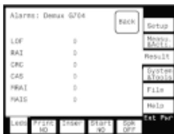
В режиме генерации цифрового потока анализатор VICTOR обеспечивает **индивидуальные установки для битов TS0 и TS16.**
