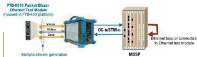
Комбинируя возможности модуля FTB-8510 по генерации и анализу нескольких потоков Ethernet и встроенный интерфейс 10/100-100M Ethernet модуля FTB-8100 вы получаете мощное решение по тестированию многочисленных сервисов в сети SONET/SDH.
