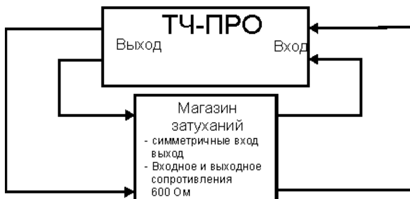
Рисунок 8.4. Проверка измерителя уровня с использованием магазина затухания.
